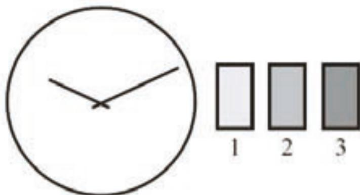
注意：時計の針が21時から3時の間にある時は、日付早送り修正をしないでください。ムーブメントに損傷を受けることがあります。
