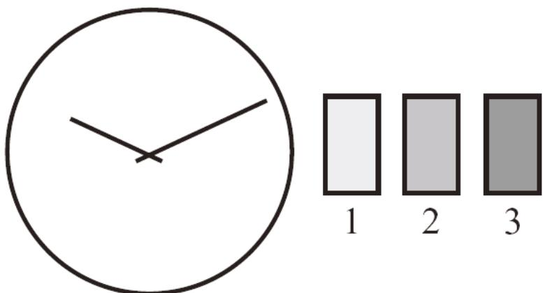
**Atención:** nunca efectuar una corrección rápida de la fecha si el reloj indica una hora comprendida entre las 21 y las 3 horas. El mecanismo podría dañarse.
