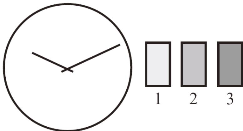
**Attenzione: non esegua la correzione rapida della data quando l'orologio indica un'ora compresa tra le 21 e le 3. Il meccanismo si potrebbe danneggiare.**
