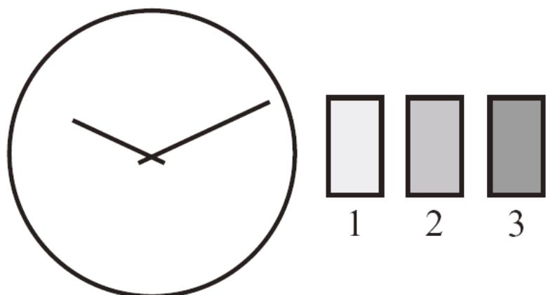
**Attention : ne jamais procéder à un réglage rapide de la date lorsque la montre indique une heure comprise entre 21 heures et 3 heures. Le mécanisme pourrait en être endommagé.**
