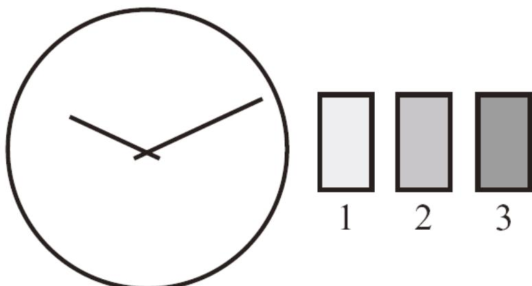
**Achtung:** Stellen Sie das Datum nicht ein, wenn die Uhr eine Zeit zwischen 21 und 3 Uhr anzeigt. Der Mechanismus könnte dadurch beschädigt werden.
