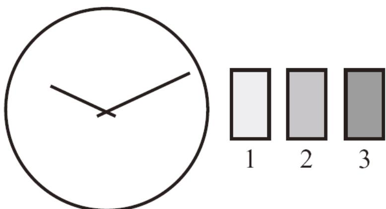
**Atenção: não realize a operação para acertar rapidamente a data quando o relógio estiver indicando uma hora entre 21 e 03. O mecanismo poderá danificar-se.**
